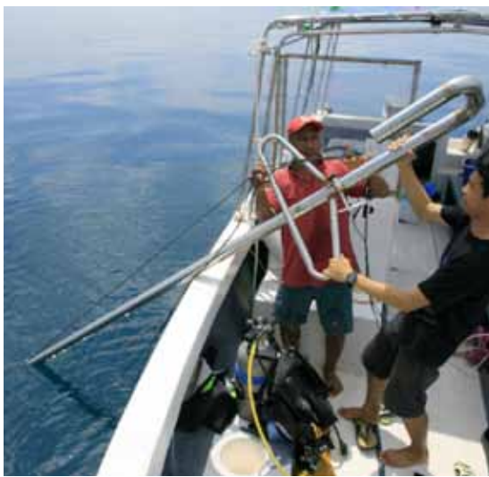
Die Halterung für die Hydrophone muss in sich stabil und vom Boot aus leicht handhabbar sein.
